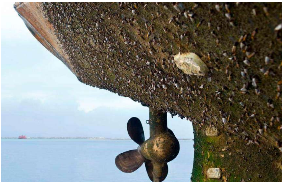
La acumulación de bioincrustaciones en casco y propela de buques puede alterar los ecosistemas con especies invasoras.
